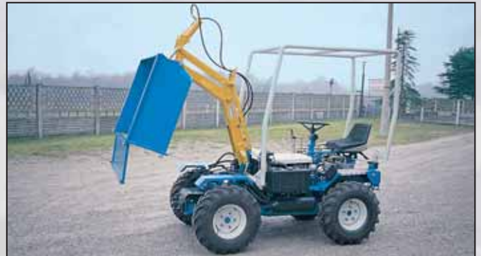
CASSONETTO SU BRACCIO PORTATTREZZI Ribaltabile idraulicamente. Dimensioni: lunghezza mm 775 - larghezza mm 1100 - altezza sponde mm 375 - capacità volumetrica lt 320 - portata utile Kg 300 - sponda anteriore apribile - elevazione massima cm 170 ÷ 220
