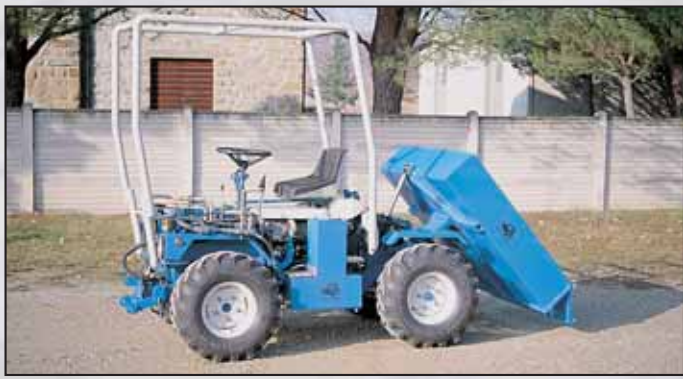
CASSONE RIBALTABILE Dimensioni: larghezza mm 1150 - lunghezza mm 1175 - altezza sponde mm 250 - Portata utile Kg 380 ÷ 390 - ribaltamento idraulico - capacità volumetrica lt 337 - sponda posteriore apribile
