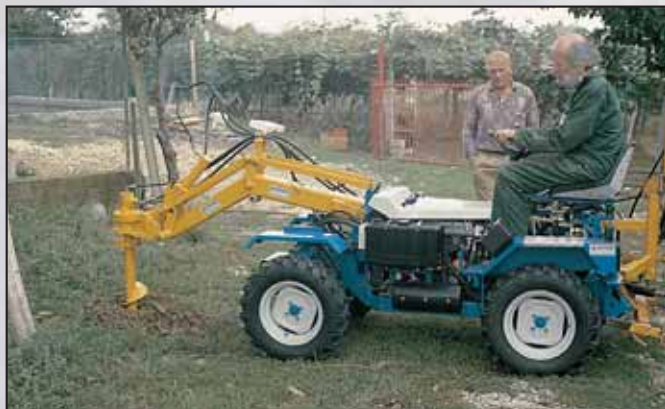
TRIVELLA OLEODINAMICA: con punte Ø max 250 mm - Lungh. 100 cm - Max numero di giri/min. 210
