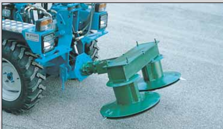
ROTOFALCE BIDISCO: larghezza lav. cm 100 ÷ 120 - N. 4 coltelli su n. 2 dischi controrotanti. Disco folle concavo di appoggio al terreno non regolabile. Peso Kg 95 ÷ 120.
