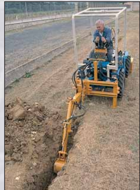
Escavatore: larghezza benna mm 270 - Capienza benna lt 14 - Angolo rotazione braccio 90° ÷ 50° a destra o sinistra - Forza strappo al dente Kg 800 - Due piedi appoggio oleodinamici indipendenti
