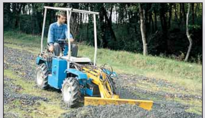
Lama livellatrice: larghezza m 1,20 - Altezza cm 38 Regolazione idraulica angolo orientamento frontale (45° a destra e sinistra) - Regolazione idraulica angolo inclinazione ± 15°
