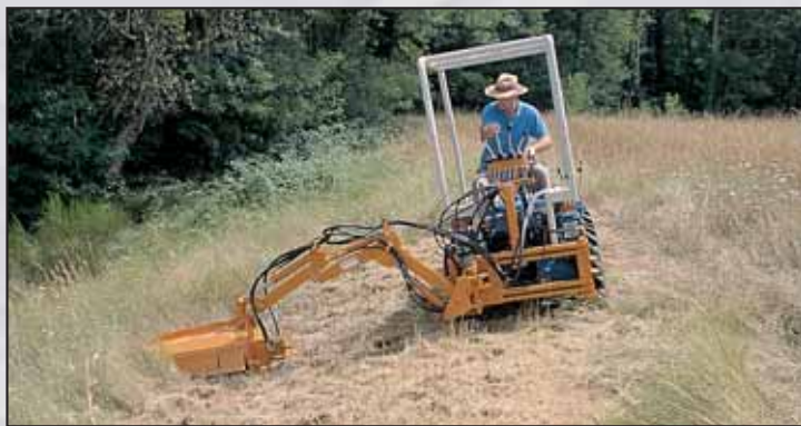
TRINCIAERBA LATERALE: Collocazione anteriore a 90° a destra o sinistra. Larghezza di lavoro 70 cm ÷ 80 cm - Distanza massima di taglio cm 250
