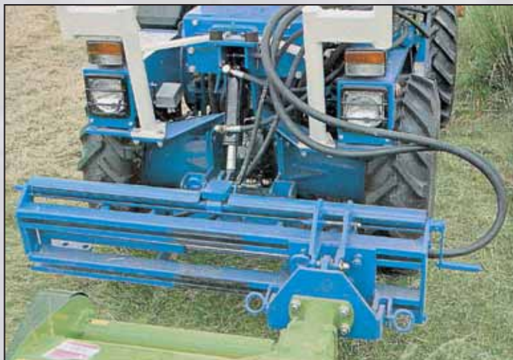
Attacco attrezzi speciale, con slitta trasversale di traslazione con comando idraulico e/o manuale
