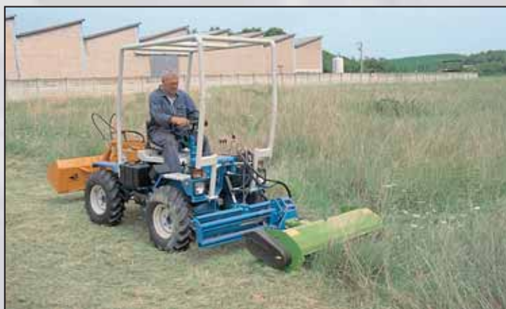
TRINCIAERBA FRONTALE Larghezza di lavoro cm 100 ÷ 120 - n. 24 ÷ 32 coltelli ad Y - Rullo di appoggio al terreno regolabile per variare l'altezza di taglio
