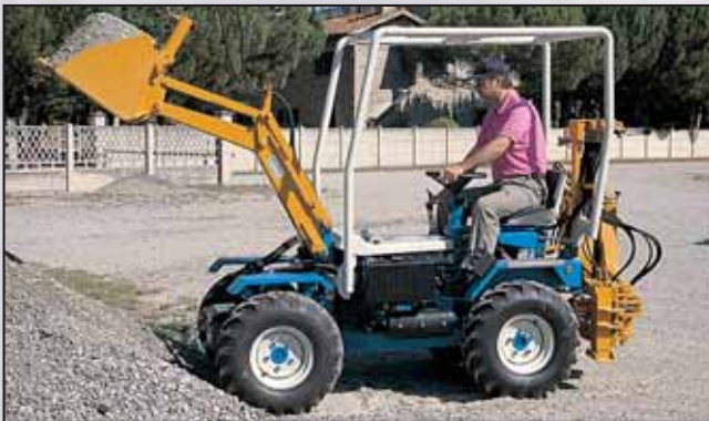
Pala caricatrice: braccio autolivellante - Larghezza cucchiaia mm 1000 ÷ 1200 - Capienza cucchiaia lt 104 ÷ 125 - Portata Kg 300
