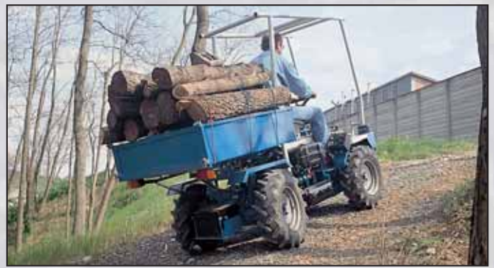
CASSONE RIBALTABILE Dimensioni: larghezza mm 1150 - lunghezza mm 1175 - altezza sponde mm 250 - Portata utile Kg 380 ÷ 390 - ribaltamento idraulico - capacità volumetrica lt 337 - sponda posteriore apribile
