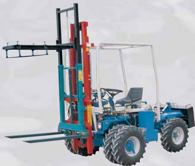
ELEVATORE A FORCHE anteriore, portata utile Kg 400 oppure Kg 600, elevazione m. 3, dotato di contrappesi spostabili idraulicamente e ruote gemellate. A richiesta, dispositivo traslazione e fermacarico
