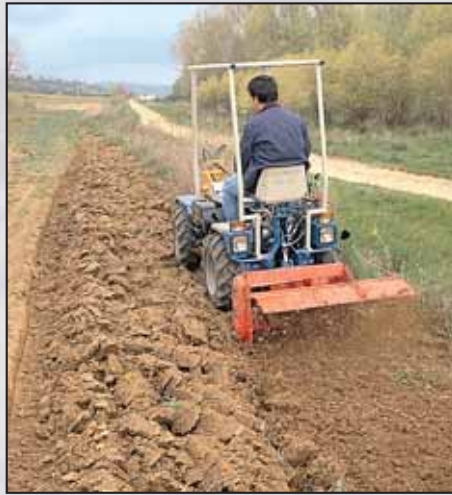
FRESA: largh. lav. 85 ÷ 100 cm spostabile trasversalmente
