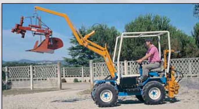
GRUETTA applicata al braccio portattrezzi - Elevazione massima gancio m 3 - Portata Kg 250
