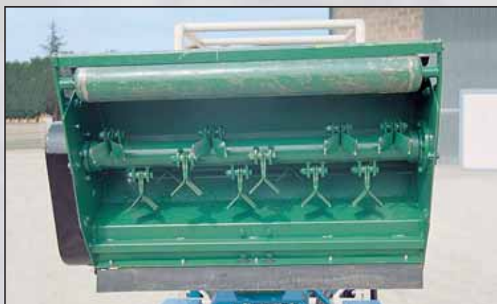
TRINCIAERBA FRONTALE Larghezza di lavoro cm 100 ÷ 120 - n. 24 ÷ 32 coltelli ad Y - Rullo di appoggio al terreno regolabile per variare l'altezza di taglio
