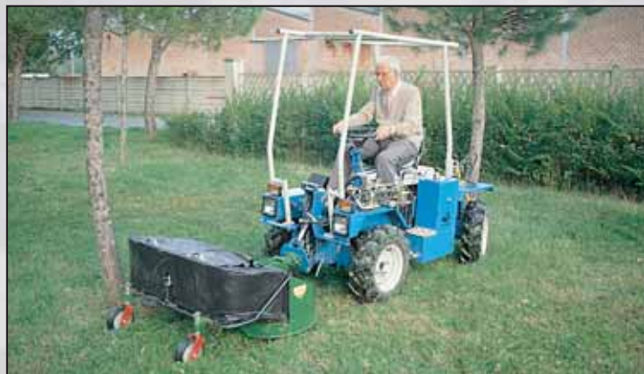
TOSAERBA: da m 1,00 a due lame orizzontali con raccogliitore. Capacità raccogliitore lt 120
