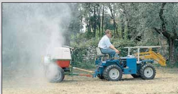
ATOMIZZATORE TRAINATO: cisterna in vetroresina da lt 200 - Ø ventola 500 mm - Pompa portata 50 lt/min. - Pressione 40 bar - Moltiplicatore ad 1 vel. con disinnesto
