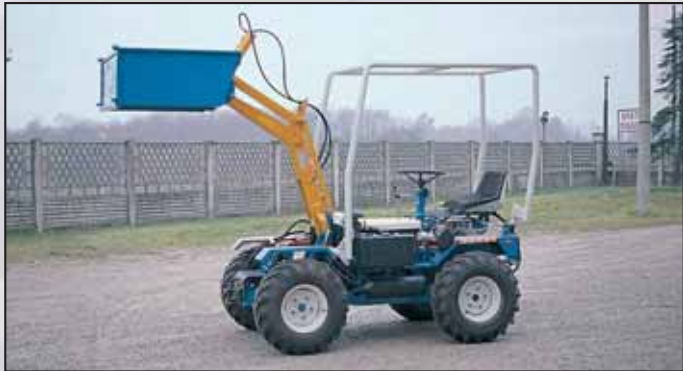
CASSONETTO SU BRACCIO PORTATTREZZI Ribaltabile idraulicamente. Dimensioni: lunghezza mm 775 - larghezza mm 1100 - altezza sponde mm 375 - capacità volumetrica lt 320 - portata utile Kg 300 - sponda anteriore apribile - elevazione massima cm 170 ÷ 220
