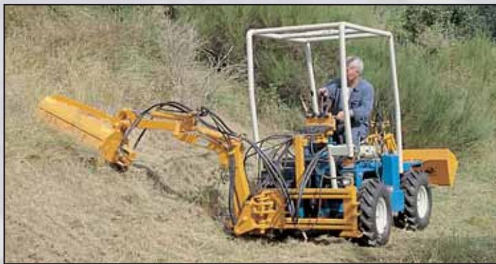
TRINCIAERBA LATERALE: Collocazione anteriore a 90° a destra o sinistra. Larghezza di lavoro 70 cm ÷ 80 cm - Distanza massima di taglio cm 250
