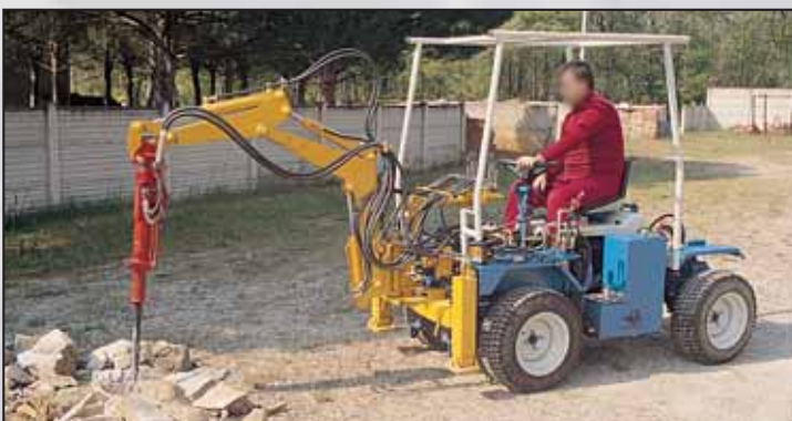
Martello demolitore oleodinamico: peso Kg 23,5 - Colpi al minuto 1120 ÷ 1150 - Pressione 80 ÷ 130 bar - Lunghezza 700 mm - Smontabile ed utilizzabile manualmente - Punta standard UPN 32 lunghezza 610 mm
