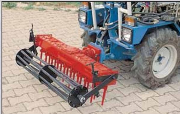
ERPICINE ROTANTE: largh. lav. 101 cm - N. 9 rotor con n. 2 denti cad. - Rullo di appoggio regolabile per variare la profondità di lavoro - Prof. lav. max 15 cm - Peso Kg 92
