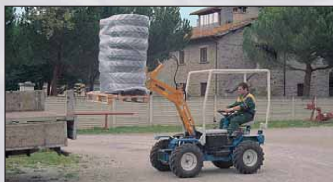
FORCA PALLETS larghezza forche regolabile - Elevazione massima forche m 1,60 ÷ 2 - Portata Kg 300
