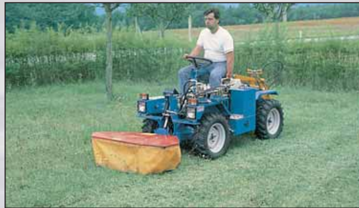
ROTOFALCE BIDISCO: larghezza lav. cm 100 ÷ 120 - N. 4 coltelli su n. 2 dischi controrotanti. Disco folle concavo di appoggio al terreno non regolabile. Peso Kg 95 ÷ 120.
