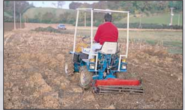
ERPICINE ROTANTE: largh. lav. 101 cm - N. 9 rotor con n. 2 denti cad. - Rullo di appoggio regolabile per variare la profondità di lavoro - Prof. lav. max 15 cm - Peso Kg 92
