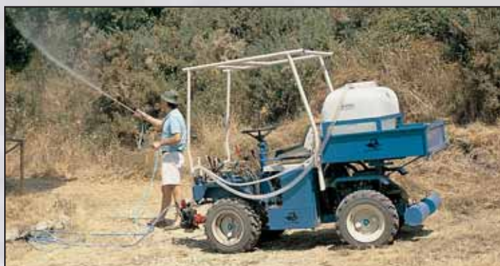
POMPA IRRORATRICE: a 3 membrane - Portata 50 lt/min. - Pressione 40 bar - Cisterna in polietilene da lt 200 - Può essere equipaggiata con lancia o barra irroratrice della larghezza necessaria
