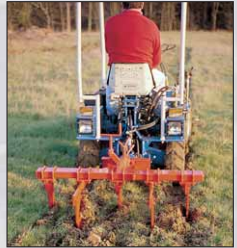
RIPPER: a 3 ÷ 5 ancore regolabili trasversalmente - Largh. lav. 100 cm - Prof. lav. max 25 cm - Peso Kg 80
