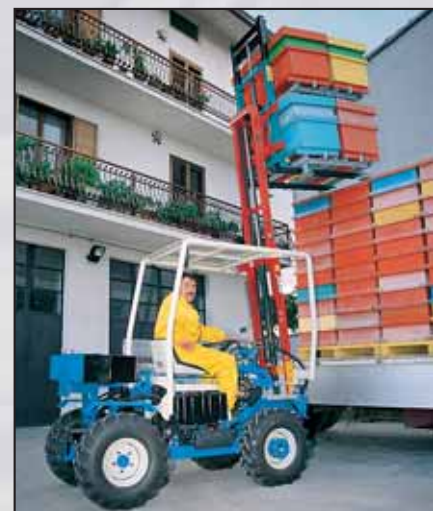
ELEVATORE A FORCHE anteriore, portata utile Kg 400 oppure Kg 600, elevazione m. 3, dotato di contrappesi spostabili idraulicamente e ruote gemellate. A richiesta, dispositivo traslazione e fermacarico
